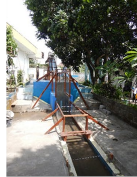
Balai Teknik Sabo Indonesiaで実施されている泥流による河床変動解析のための屋外実験施設)
