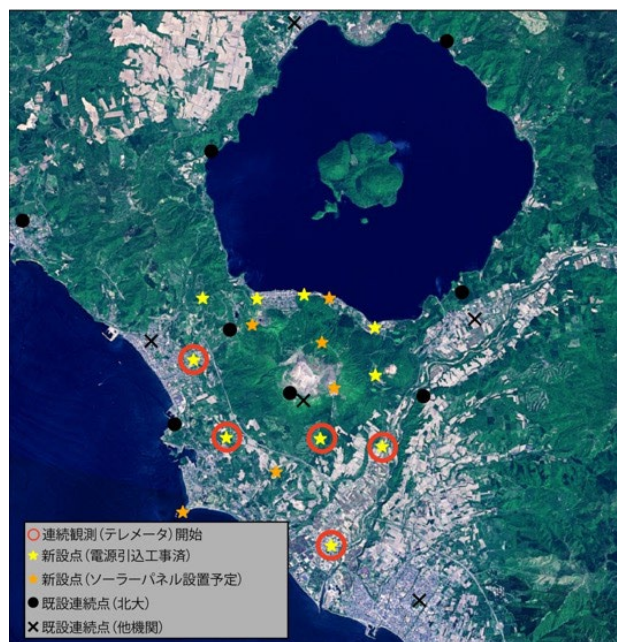
図 2. 有珠山一帯の GNSS 観測施設配置と 2023 年度の整備作業箇所。
