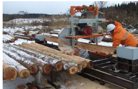
写真－1 移動式製材機によるオンサイト製材
